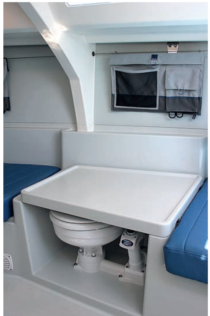
Auch ein See-WC kann in der Kabine untergebracht werden.
