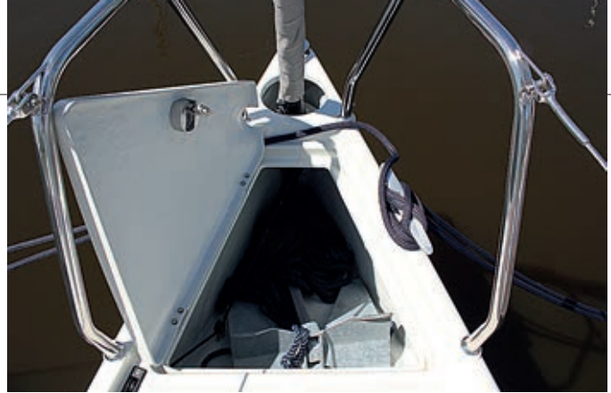
Auch auf knapp acht Meter Bootslänge wird ein Ankerkasten angeboten.
