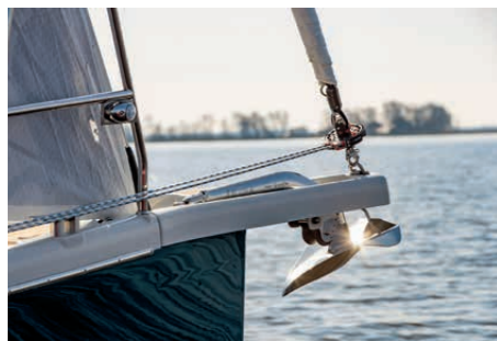
Der Bugsprit dient auch als Ankerhalterung. Die Vorsegel-Rollanlage ist versenkt eingebaut
