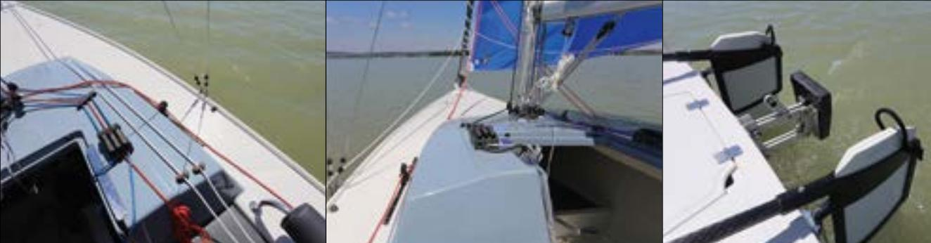
**Windsbraut.** Das Segeln ist reine Freude: Die Pointer springt rasch an, läuft gute Höhe und entwickelt unter Gennaker erfri-schende Agilität. Das Deckslayout ist ausgereift, die Doppelruderanlage bekommt in Zukunft etwas mehr Vorbalance
