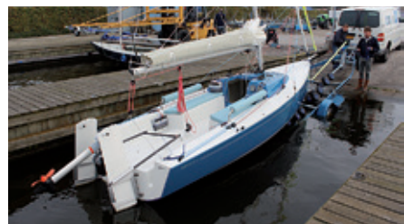
Das Slippen der Kleinyacht ist kein Problem: Ohne den Trailer vom Zugfahrzeug abzukoppeln, gleitet die Pointer ins Wasser.
