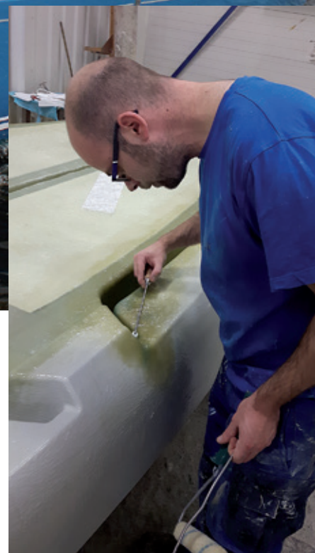
Sorgsam wird die Yacht laminiert: für höchste Qualitätsansprüche und sparsamen Materialverbrauch.
