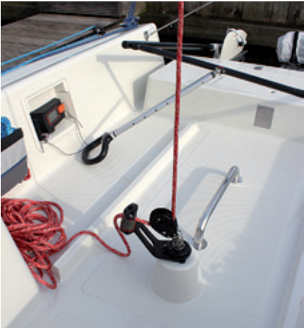
Im aufgeräumten Cockpit wird die Großschot in der Mitte geführt, so dass sie von Steuermann und Vorschoter gleichermaßen zu bedienen ist.
