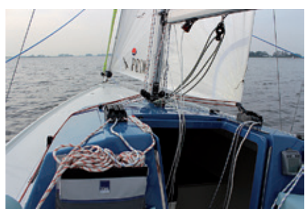
Die Fallen und Strecker werden auf das Kajüt-Dach geführt und werden aus dem Cockpit bedient.
