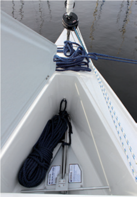
Der Ankerkasten im Bug ist üppig bemessen und soll in künftigen Versionen etwas verkleinert werden – zugunsten der Kabinenfülle.
